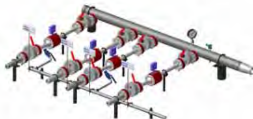
Вариант исполнения блока напорной гребенки без рамы
